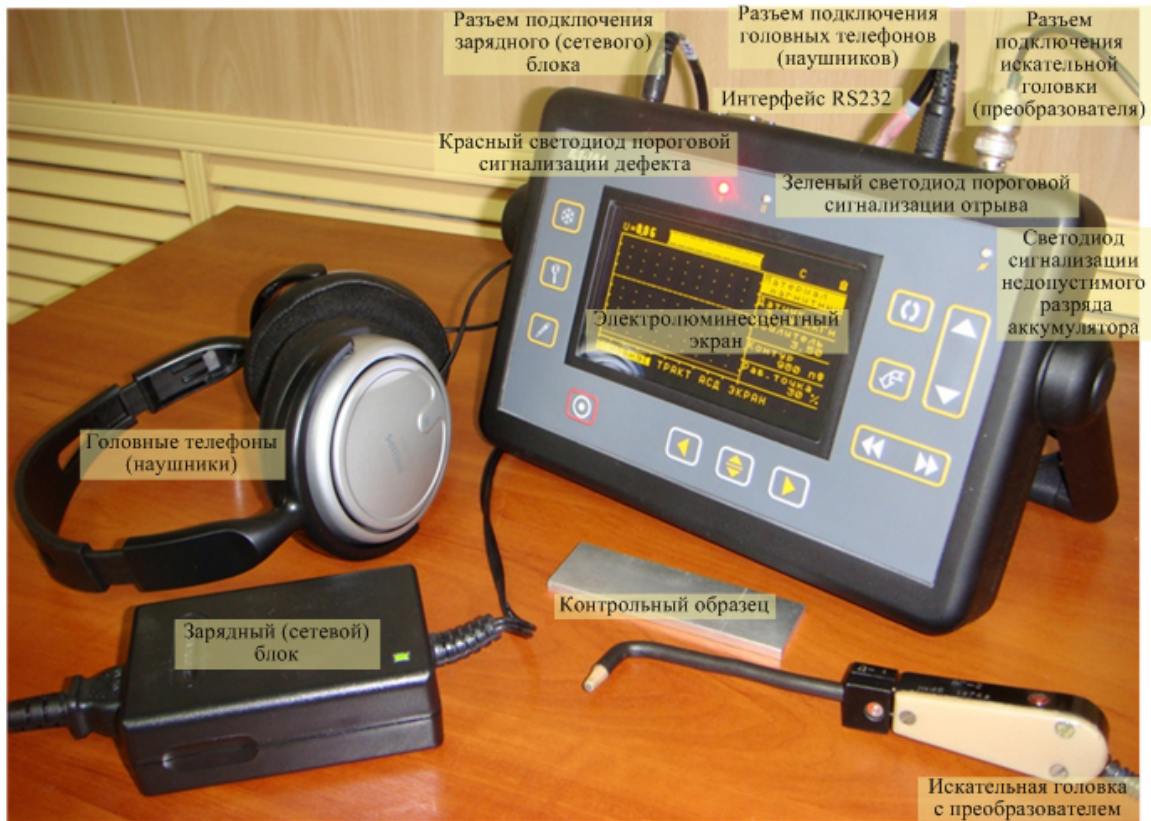
Рисунок 2 - Комплект дефектоскопа ВД-10А
