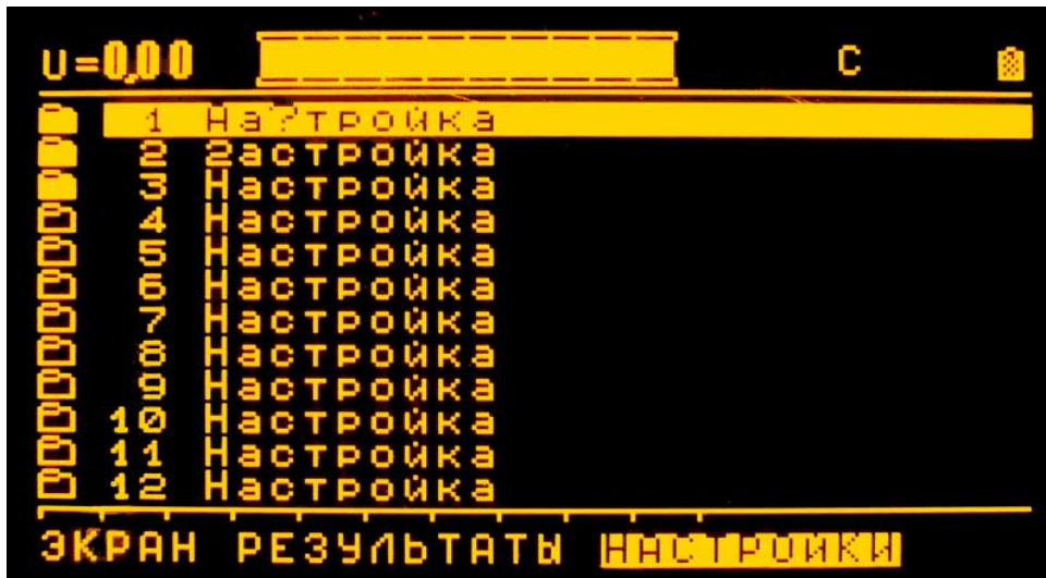
Рисунок 6 – Вид экрана дисплея дефектоскопа ВД-10А с выведенным списком настроек, содержащихся в его памяти. Занятые папки (файлы) подсвечены
